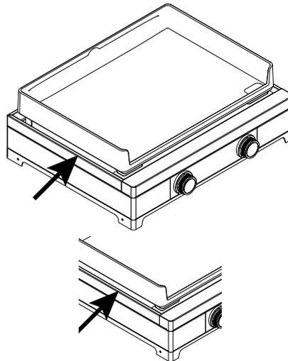
Il est conseillé de vider et de nettoyer le bac à graisse, après chaque utilisation. Le bac à graisse doit être manipulé quand votre plancha est froide.
