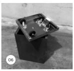
05 & 06: Montieren Sie sowohl die Lenk- und Bockrollen mit den beigefügten Schrauben und Muttern.
